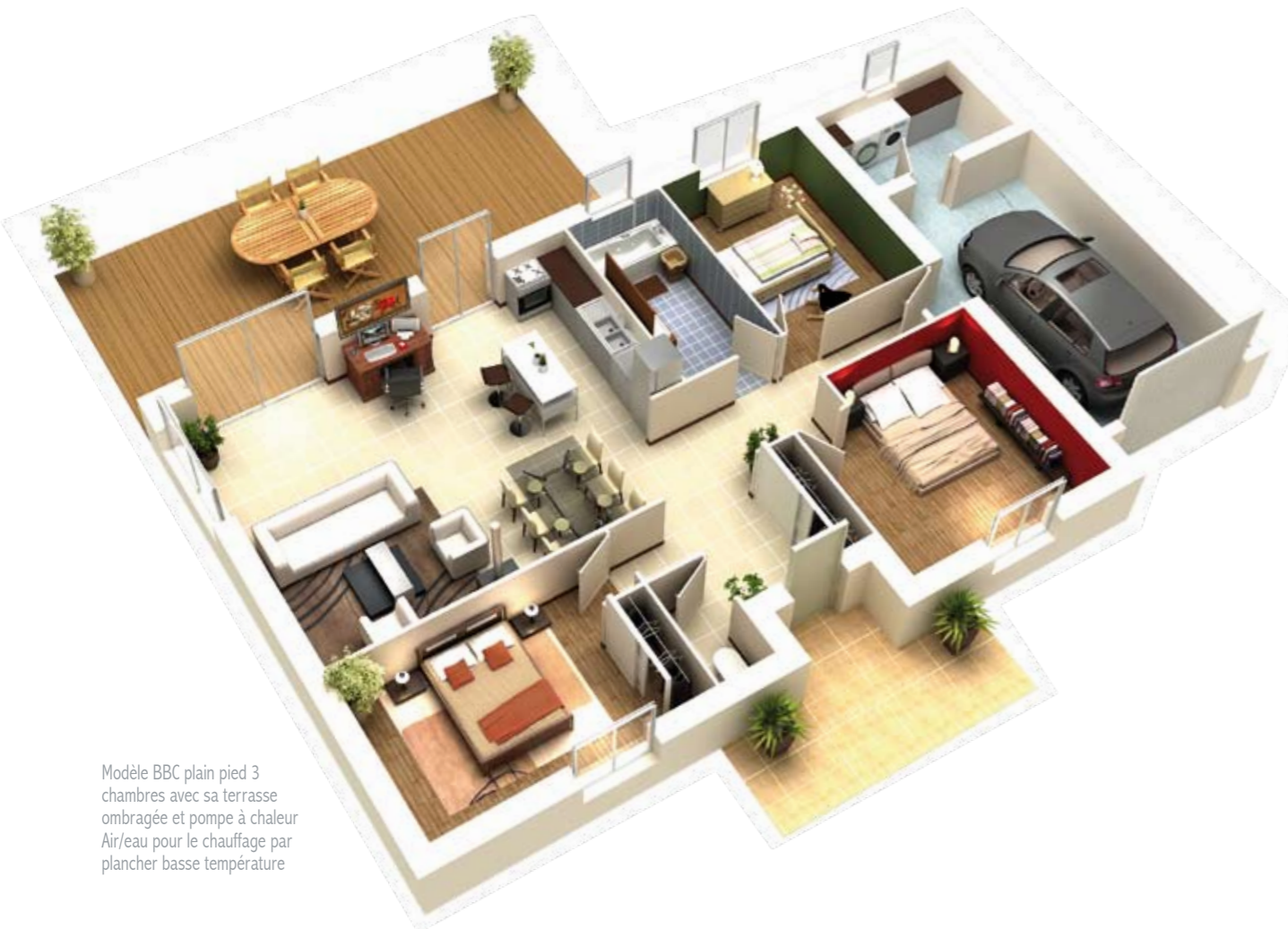
Cette maison BBC de volumes simples a fait l'objet d'une étude thermique rigoureuse avant sa présentation sur le marché. La pergola en bois à lames orientables crée une ombre en été ; « un brise soleil » qui évite ainsi le besoin d'un refroidissement mécanique (clim,...)
